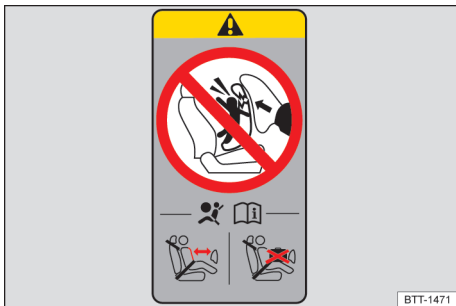
Kuva 2 Turvatyynytarra A- tai B-pilarissa (periaatekuva).
