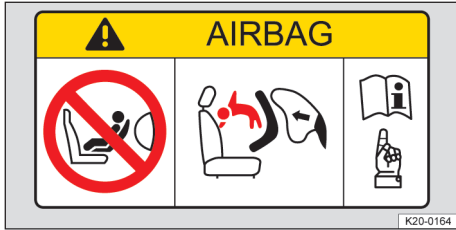
Kuva 1 Turvatyynytarra häikäisysojassa (periaatekuva).
