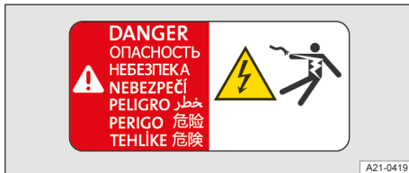
Kuva 3 Varoituskilpi korkeajännitekomponenttien päällä.
