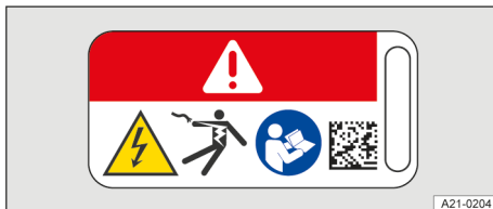
Kuva 4 Varoituskilpi korkeajännitekomponenttien päällä.
