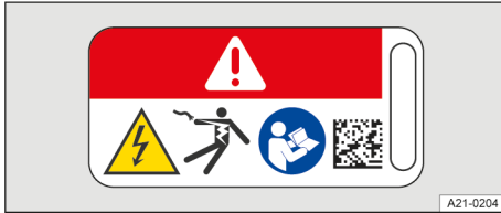
Kuva 5 Varoituskilpi korkeajännitekomponenttien päällä.
